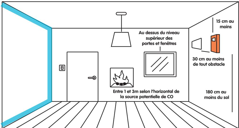
Dans la pièce où se trouve l'appareil à combustion : Le détecteur doit être placé entre 1 et 3m à l'horizontal de la source potentielle de CO, à au moins 1,80m du sol et 15cm du plafond. Dans les pièces à vivre : relativement proche de l'espace où respirent les occupants
