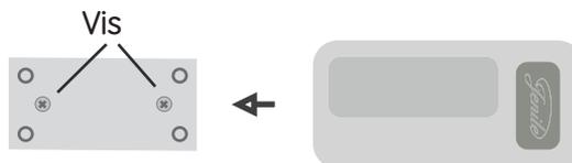
Ce bouton se fixe sur le mur à côté de la porte, avec des vis ou du scotch double face (inclus). Il est adapté pour l'intérieur (immeuble).
